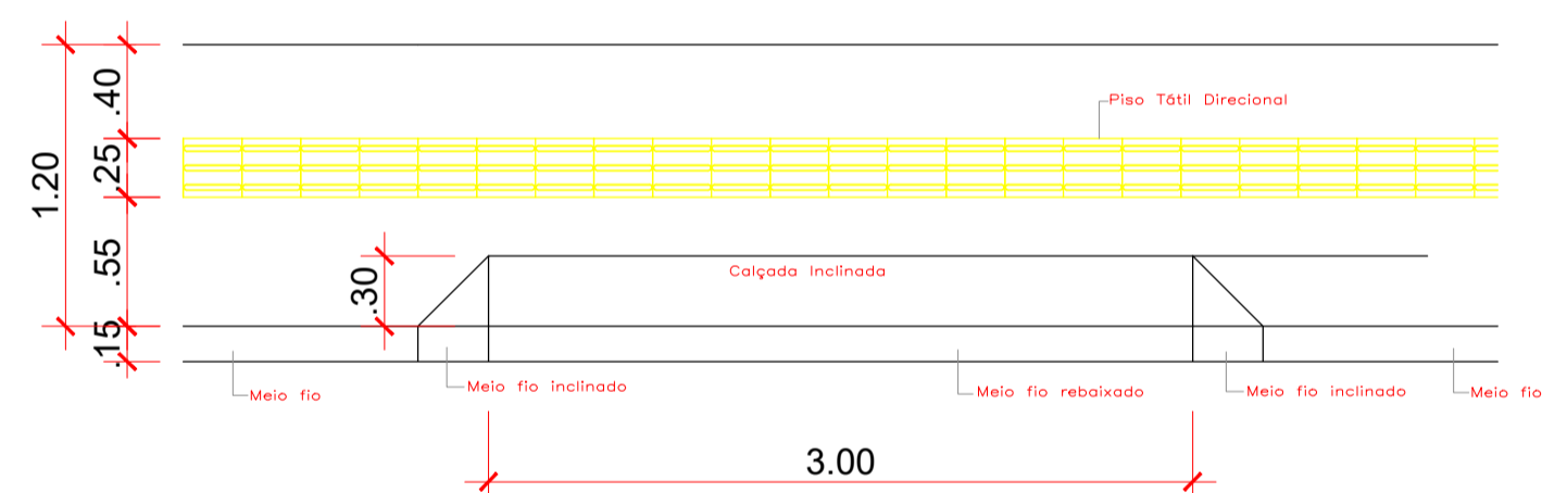
DETALHE REBAIXAMENTO MEIO FIO Esc.: 1/35
