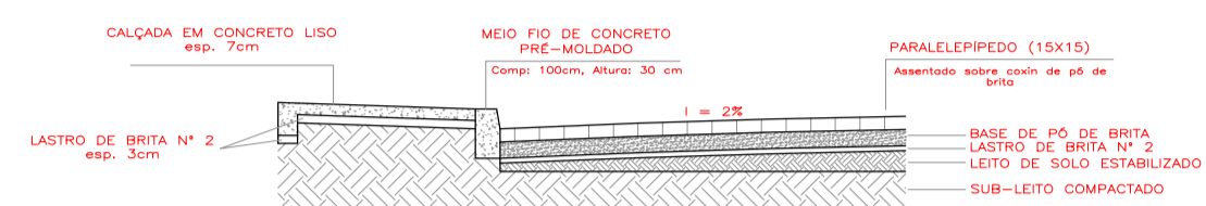
DETALHE PERFIL TRANSVERSAL Esc.: 1/50
