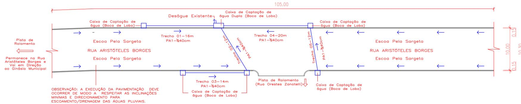
OBSERVAÇÃO: A EXECUÇÃO DA PAVIMENTAÇÃO DEVE OCORRER DE MODO A RESPEITAR AS INCLINAÇÕES MÍNIMAS E DIRECIONAMENTO PARA ESCOAMENTO/DRENAGEM DAS ÁGUAS PLUVIAIS.
