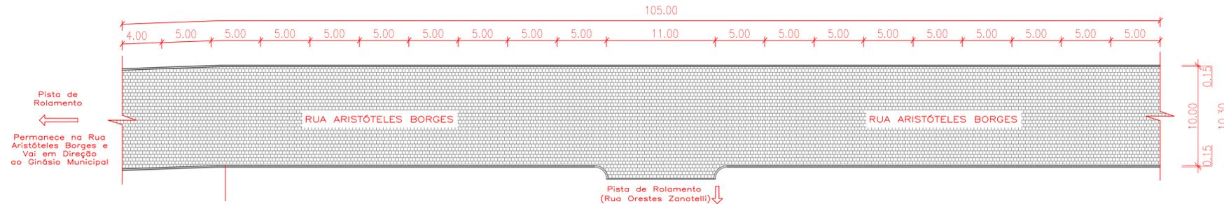
OBSERVAÇÃO: TODOS OS REBAIXOS DE MEIO FIO SEGUEM A LOCALIZAÇÃO DOS ACESSOS DAS CASAS E TERRENOS EXISTENTES. OS MESMOS DEVEM SER EXECUTADOS CONFORME OS DETALHAMENTOS 01 E 02 DE REBAIXO DE MEIO FIO.
